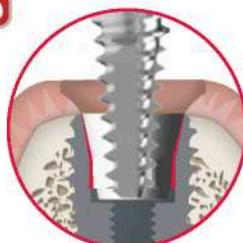
Используйте динамометрический ключ, чтобы удалить состояние холодной сварки во внутренней части имплантата и поврежденный абатмент.
